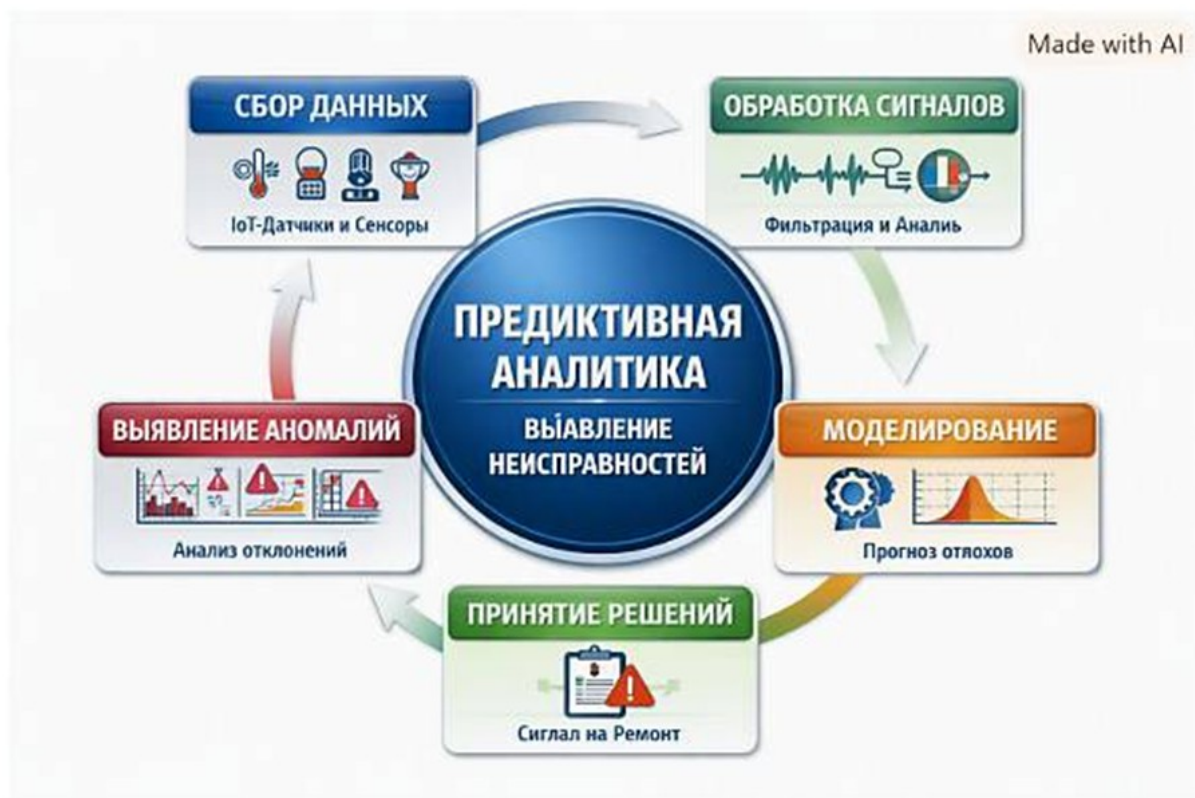
Рисунок 1 - схема жизненного цикла предиктивной аналитики для выявления неисправностей оборудования.
